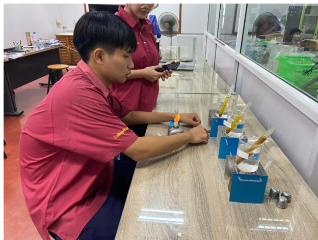
ภาพที่ 2 การสกัดแทนนินจากฐานรองดอกของดอกสุพรรณิการ์ด้วยตัวทำละลายที่ต่างกัน
