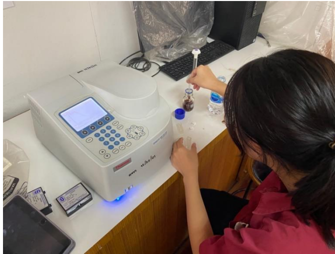
ภาพที่ 3 การตรวจสอบค่าดูดกลืนแสงของแทนนินจากฐานรองดอกเห็ดเทียบกับสารบริสุทธิ์ของ ตัวทำละลายด้วยเครื่อง Spectrophotometer
