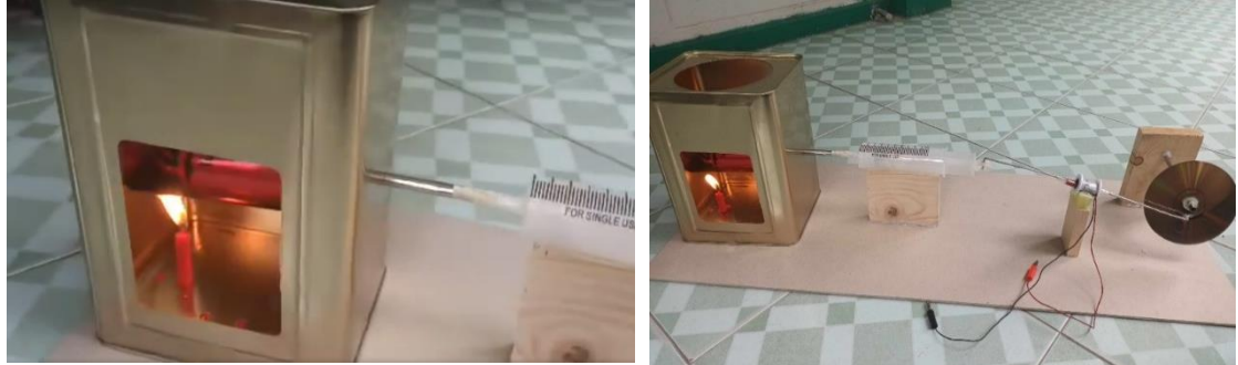
ภาพที่ 5 ทดลองใช้งานเตาเผาขยะผลิตกระแสไฟฟ้า จากการเหนี่ยวนำแม่เหล็กไฟฟ้าโดยการให้ความร้อน
