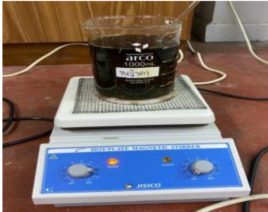
ภาพที่ 7 ต้มในสารละลายโซเดียมไฮดรอกไซด์ (NaOH)
