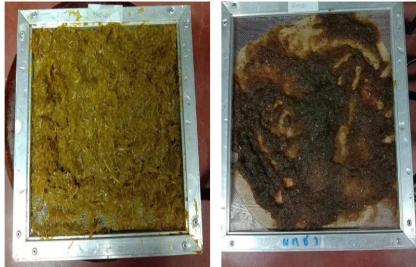
ขึ้นรูปตะแกรงตากเส้นใย โดยมีขนาด 15 x 24 ตารางเซนติเมตร
