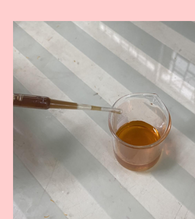
แยกส่วนของดอกสุพรรณิการ์และนำไปทดสอบกับสาร Fe(NO_3)_3 ในสัดส่วนปริมาณที่เท่ากันและเลือกส่วนที่มีแทนนินมากที่สุด
